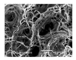
a. Ductile fracture
